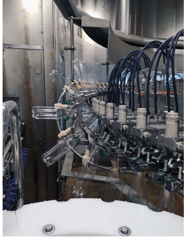
Die Flaschen schwenken über die Düse, die daraufhin nach erfolgter Schwenkbewegung in die Flasche eintaucht.
