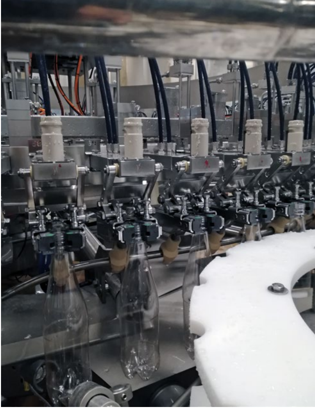
Die Flaschen werden vom Transportstern an den Rinser übergeben.
